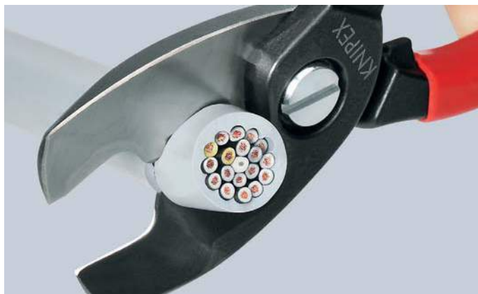
Dokončovací řez: po prostříhnutí pláště kabelu v předním profilu se vodiče oddělí v zadním profilu. Přípravný řez vpředu, dokončovací řez vzadu – řezání je tak snazší.
