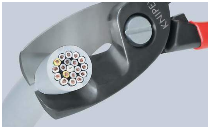
Přípravný řez: díky použití předního břitu pro řez izolačního opláštění zůstává u větších průřezů kabelů zachováno ergonomické rozevření rukojetí.
